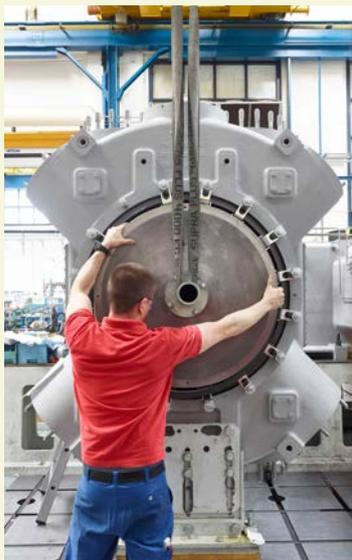
Auf die richtige Oberflächenrauheit kommt es an. Wie eingehende Analysen zeigten, war die Oberfläche der Zylinderlaufbuchse zu glatt.
